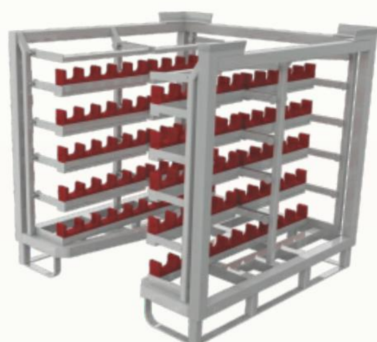
Rack para transporte de capa de alojamento do amortecedor
