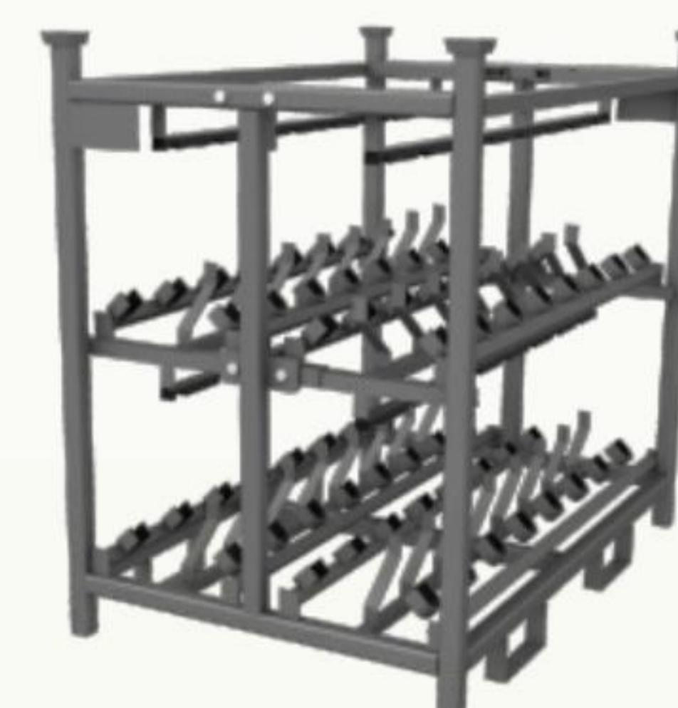
Rack para armazenamento de volante
