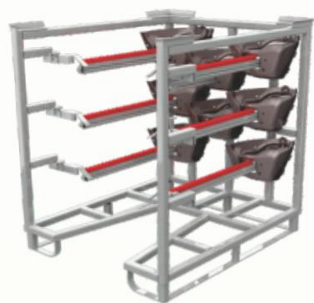
Rack para transporte de capa da lanterna interna traseira
